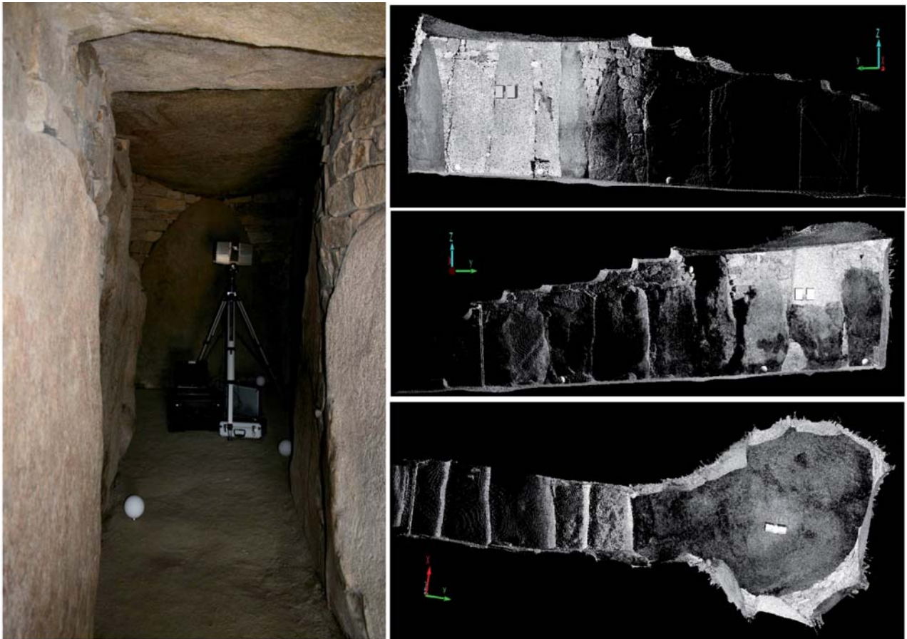
Fig. 5. Le scanner laser FARO LS en acquisition à l'intérieur de la Table des Marchands ; vues en coupe gauche, droite et vers plafond (acquisition C. Bouillon 2007 ; photo C. Bouillon ; DAO S. Cassen).
